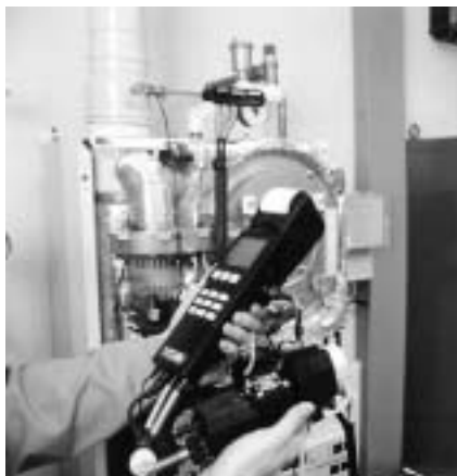
Abb. 30: Der Gastrockner garantiert präzise Messwerte und schützt das Messgerät testo 300 vor Schäden durch Kondensat.
