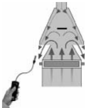
Abb. 27: Detektion von austretenden Abgasen an der Strömungssicherung mit Rückstamelder testo 317-1
