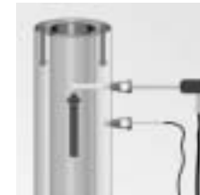
Abb. 9: Temperaturmessung an einem LAS-Kamin
