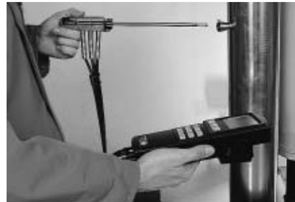
Abb. 14: Ermittlung des Abgasverlustes
