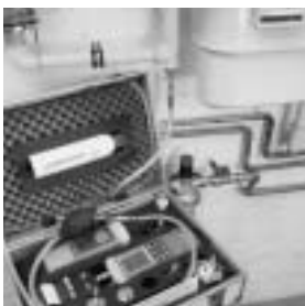
Vorprüfung mit testo 312-3
