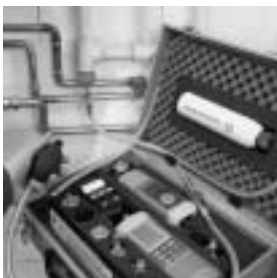
Hauptprüfung mit testo 312-2/3
